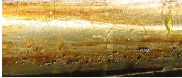
图 3.18 球磨机小齿轮根部的初期点蚀
