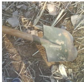
图 3.17 铁锹的磨料磨损
