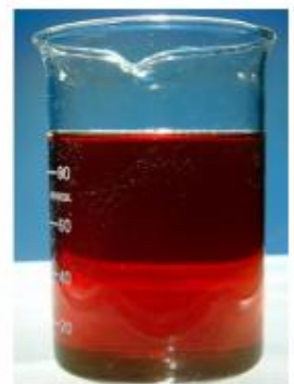
可在润滑油中稳定分散的表面修饰纳米颗粒
